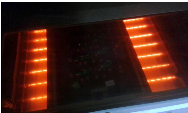
Fotografia 14: Płytką w trakcie lutowania automatycznego w tzw. piecu.
