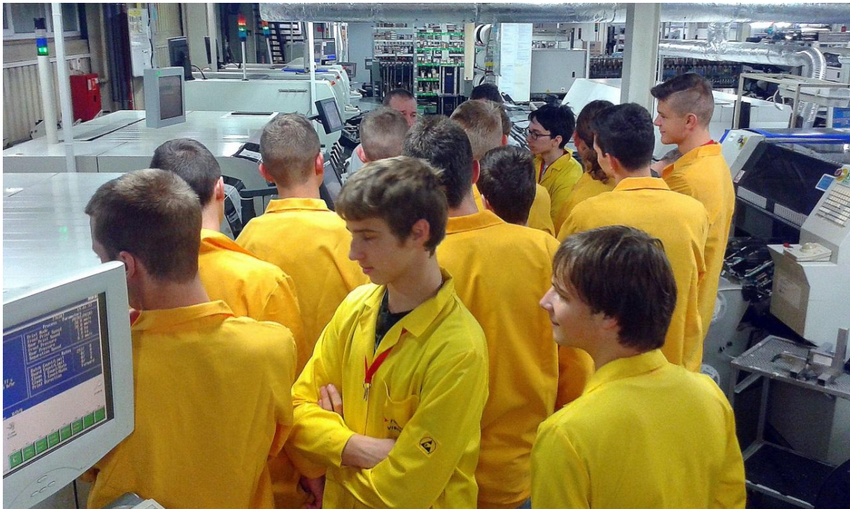
Fotografia 8: Linia produkcyjna automatycznego montażu elementów elektronicznych na płytkach PCB w technologii montażu powierzchniowego (technologia SMD).
