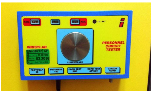
Fotografia 5, 6: Tester prawidłowości odprowadzania ładunków elektrostatycznych
