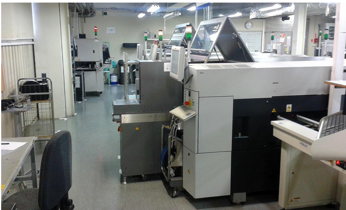
Fotografia 13: Linia produkcyjna do automatycznego montażu elementów elektronicznych w technologii montażu przewlekane (technologia THT).
