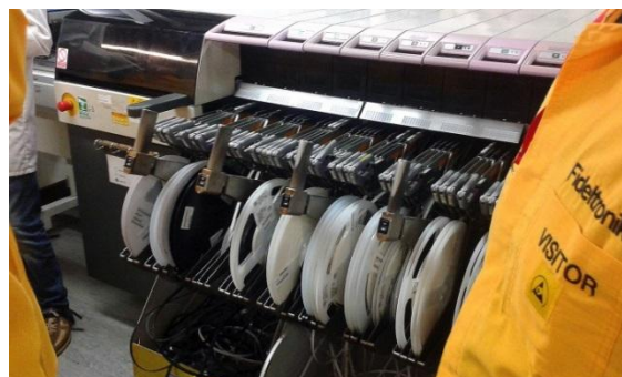
Fotografia 6: Jedna z układarek elementów SMD.
