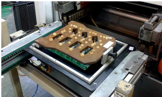
Fotografia 15: Zabezpieczenie elementów elektronicznych przed przegrzaniem
